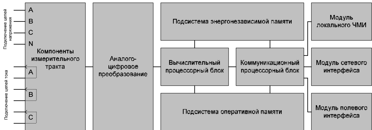
Рисунок Г.1 - Функциональная структурная схема счетчика
